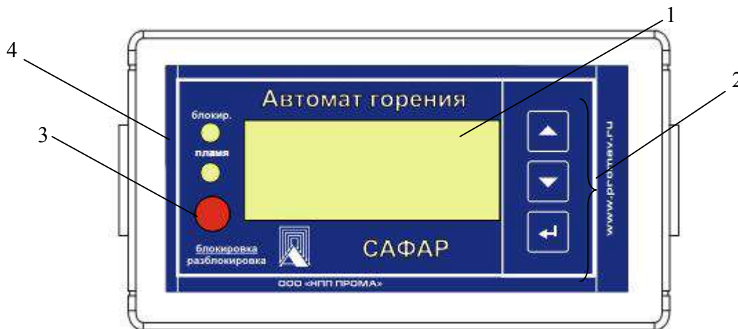
Рисунок 2. Лицевая панель блока управления САФАР. 1 – OLED; 2 – кнопки управления; 3 – кнопка возврата; 4 – светодиоды.
